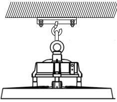
**Nota:** En caso de requerir la instalación sobrepuesta con el bracket fije este al techo o pared utilizando taquetes y pijas, una vez montado el luminario sobre la superficie ajuste el angulo deseado y asegure ajustando los tornillos que unen el bracket al luminario.
