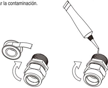
4. Ajuste el accesorio apretando con los dedos, y posterior ajuste a la posición correcta con ayuda de una llave. Un acoplamiento total de la rosca con los accesorios correctamente ensamblados debe ser de 3.5 a 6 vueltas.
