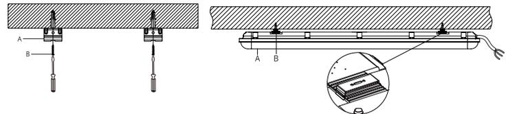
5. Para instalación suspendida inserte los ganchos a través de los soportes de montaje y fije con cable acerado o cadena.
