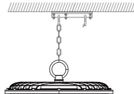
**Nota:** En caso de requerir la instalación sobrepuesta con el bracket fije este al techo o pared utilizando taquetes y pijas, una vez montado el luminario sobre la superficie ajuste el angulo deseado y asegure ajustando los tornillos que unen el bracket al luminario.
