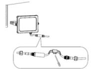
**Nota:** Para realizar la conexión del luminario es importante el uso de conectores o cajas de conexión herméticas (IP 65) que no permitan la entrada de humedad al luminario a través del cable de alimentación lo cual es pérdida de garantía en el producto.
