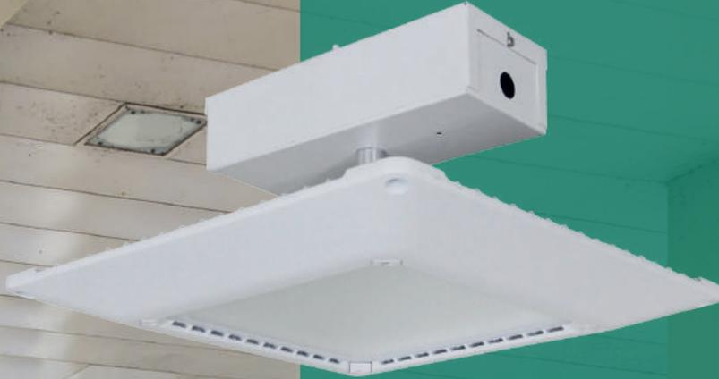
Luminaria industrial tipo High-Bay para instalaciones sobrepuestas y/o con canope, construida en aluminio fundido a presión color blanco, con optica PMMA de alta transmitancia, diseñada para una excelente distribución luminosa. Cuenta con protección IP65. Reemplazo ideal de luminarios canope de HID, para instalaciones en dobles alturas, casetas de peaje y gasolineras
