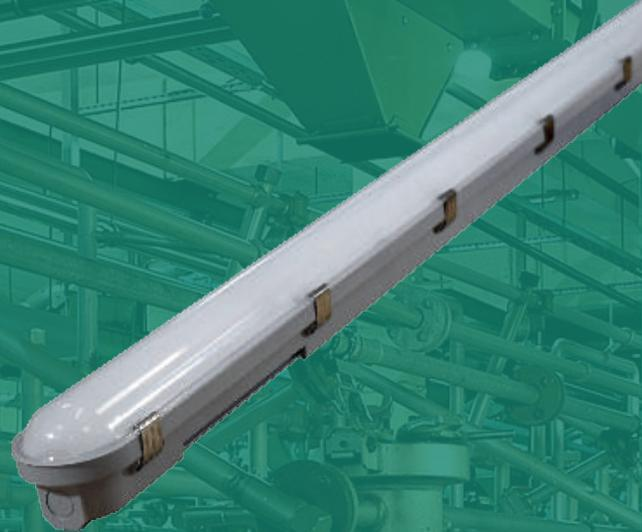
Luminario watterproof con cuerpo de ABS y difusor de policarbonato que integra una batería de emergencia en su cuerpo con autonomía de 3 horas. Ideal para aplicaciones con ambientes húmedos (vapor, salpicaduras, etc) y que requieran un respaldo en caso de falla de energía, como estacionamientos, cámaras de refrigeración e industria en general. Montaje sobrepuesto / suspendido. Disponible en 2 potencias: 36W y 50W.
