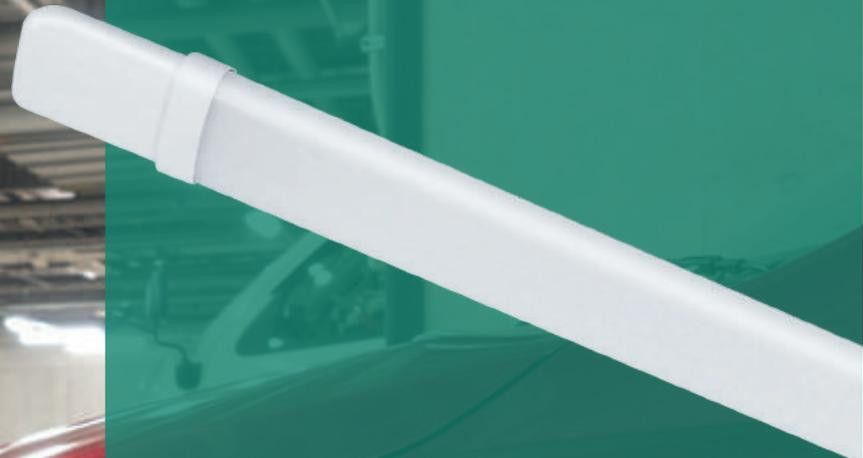
Luminario tipo batten que gracias a sus características puede utilizarse en cámaras de refrigeración, cuartos de calderas, garages, o cualquier otra aplicación donde el sistema de iluminación este expuesto a la humedad y/o polvo. Cuerpo fabricado en policarbonato con acabado blanco y difusor opalino de policarbonato para una proyección uniforme de luz.
