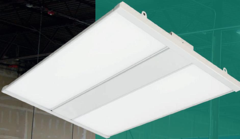
Iluminación de alta calidad para instalación en grandes superficies y alturas; ideal para comercios y bodegas. Fabricado en acero laminado con acabado en pintura electrostática color blanco y difusor opalino de policarbonato. Diseño ligero que facilita la instalación del luminario y que mantiene una adecuada gestión térmica. Incluye accesorios para montaje suspendido.
