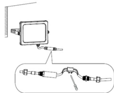
**Nota:** Para realizar la conexión del luminario es importante el uso de conectores o cajas de conexión herméticas (IP 65) que no permitan la entrada de humedad al luminario a través del cable de alimentación lo cual es causa de pérdida de garantía del producto.
